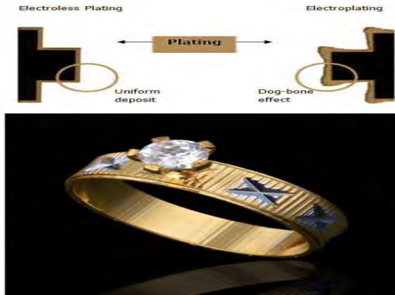
चित्र 2.3.3 इलेक्ट्रोलेस प्लेटिंग
